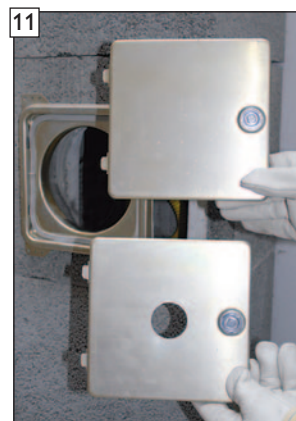
11 BlowerDoor Kondensat- blendentürblatt wieder einsetzen.
