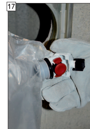
17 Verriegelung des BIB-Con- nectors öffnen und BIB-An- schlusshahn mit dem Kondensatauffangbeutel aus dem Kupplungsteil heraus- ziehen.
